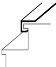
Aufgrund gewisser bauseitlicher Gegebenheiten kann es erforderlich sein, dass eine TYP C-2 Treppenkante über eine bestehende Treppennase geschoben werden soll. In diesen Fällen geben Sie uns bitte die exakten Innenmaße für Höhe und Unterkante in der Aufmaßliste an.
